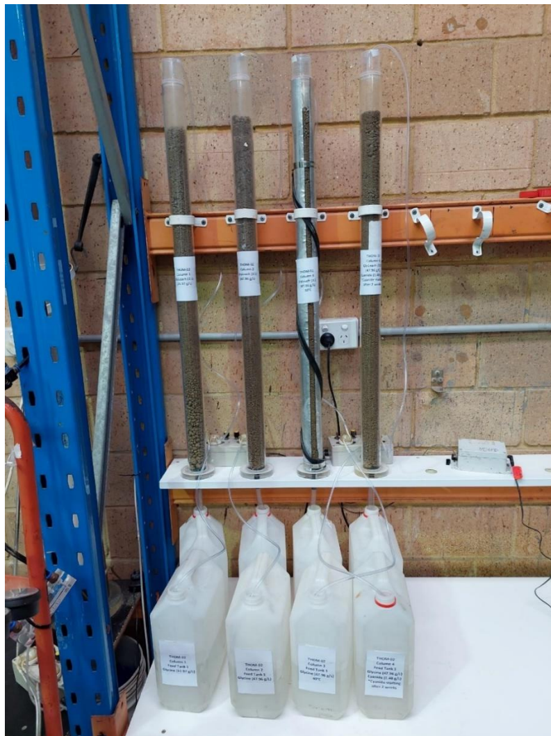
Photo 2: Mini Columns setup
