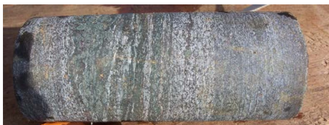
Photo 1 : Magnetite-quartz-garnet-chlorite Gneiss (Drillhole NESD011)
