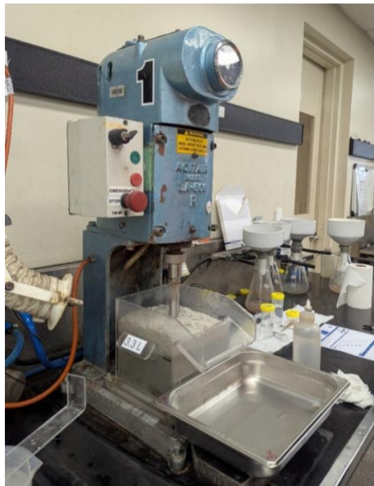
Figure 2: Cleaner flotation trial at ALS Metallurgy
