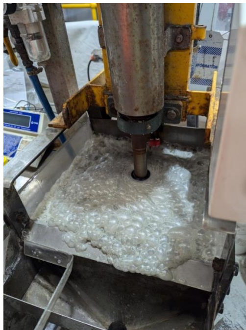
Figure 1: Bulk rougher flotation trial at ALS Metallurgy
